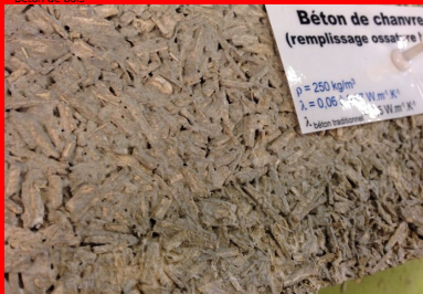
Béton de chanvre
