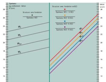
Fig 32. Détermination de l'épaisseur du revêtement béton (classe 5)
