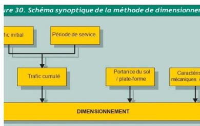
Fig 30. Schéma synoptique de la méthode de dimensionnement
