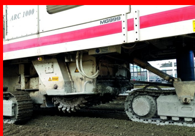
En plus de son rotor de 2 m de largeur avec 224 dents, l'ARC 1000® est équipé d'une lame flottante pour assurer le nivellement du fond de forme, d'un malaxeur, d'une vis de répartition et d'une lame de répandage. Outre la précision des dosages, l'homogénéité transversale et verticale du traitement est assurée par un malaxeur de centrale puissant.
