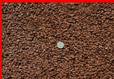
Perméable, avec un haut niveau d'absorption permettant de gérer les épisodes pluvieux exceptionnels (niveau de drainabilité pouvant atteindre 50 l/m 2 /s ou vitesse de percolation pouvant aller jusqu'à 5 cm/s).
