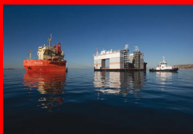
Fabriqués en Pologne, le caissonnier Marco Polo a été convoyé sur un navire submersible à travers la mer du Nord, la Manche, l'Atlantique, le détroit de Gibraltar et enfin la Méditerranée. Il est arrivé au Grand Port de Marseille après un périple de 14 jours.
