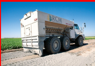
L'épandeur à liant de RCM.
