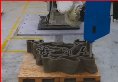
L'imprimante en action : la tête d'impression déverse peu à peu le béton, selon la numérisation des plans (Seabooost et XtreeE).
