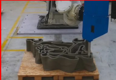
L'imprimante en action : la tête d'impression déverse peu à peu le béton, selon la numérisation des plans (Seaboost et XtreeE).
