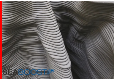
Détail des différentes couches imprimées en 3D.
