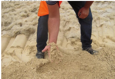
Aspect homogène du matériau après malaxage.
