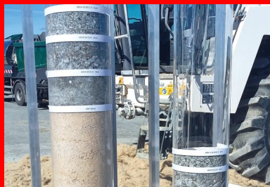
Photo illustrant le gain de matériau et l'économie de ressources naturelles que la structure innovante a engendrés (à gauche, structure traditionnelle avec couche de forme non traitée ; à droite, structure innovante avec couche de forme traitée).
