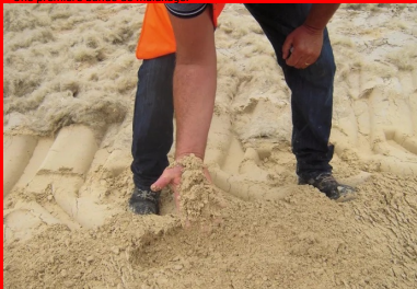
Aspect homogène du matériau après malaxage.
