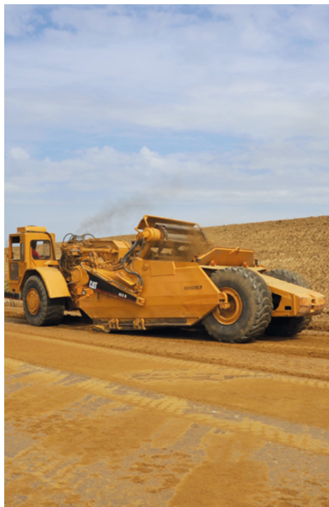
▲ Le Scrap extrait les argiles pour ré-utilisation.
