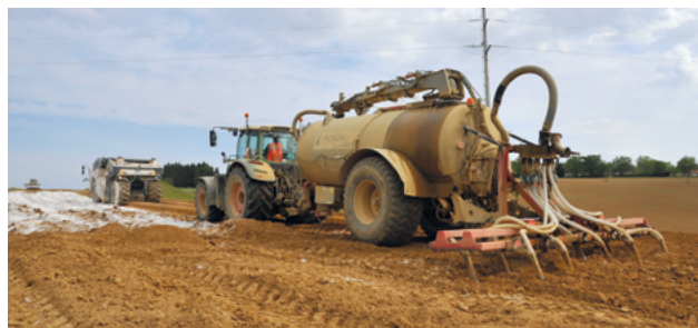
▲ L'arroseuse à enfouissement garantit une teneur en eau optimale.
